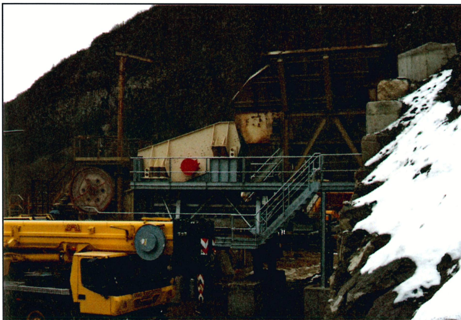
Crible Scalpeur FSI 52 Sovemat, Bourg d'Oisans (Isère)
